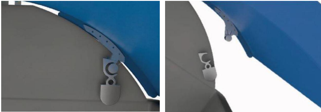
Figura 3. Exemple de sistema per dificultar el robatori del paper-cartró en contenidors de càrrega lateral (I/II): instal·lació de ganxos pendulars dobles als laterals de la tapa.
